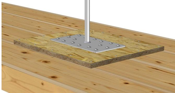
**Point d'ancrage** pour fixer l'EPI contre les chutes
