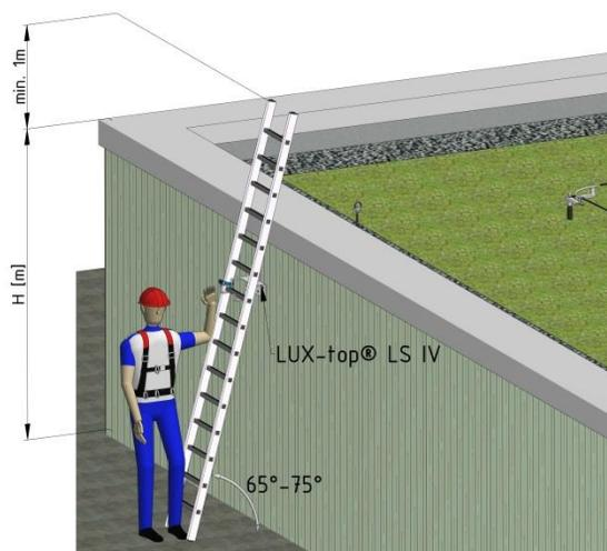
Fig. 2 : Mise en place exacte de l'échelle simple
