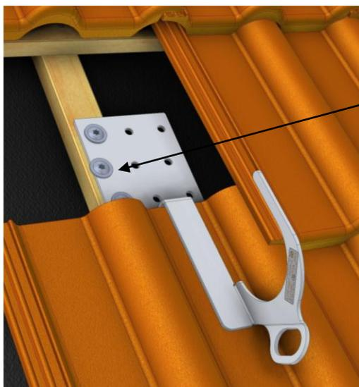
Schraubenlänge **L** wird in Abhängigkeit vom vorhandenen Dachaufbau festgelegt.
