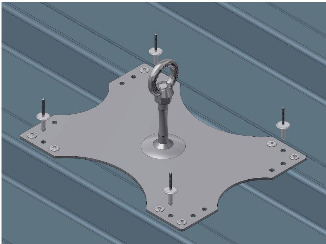
***Point d'ancrage pour la fixation de l'équipement de protection individuelle antichute (EPIA) pour un maximum de 3 personnes ainsi que pour l'utilisation dans des systèmes de câbles LUX-top® selon DIN EN 795:2012 type C***
