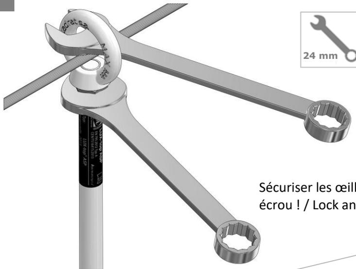
Sécuriser les œillets d'ancrage avec un contre-écrou ! / Lock anchor eyebolts!
