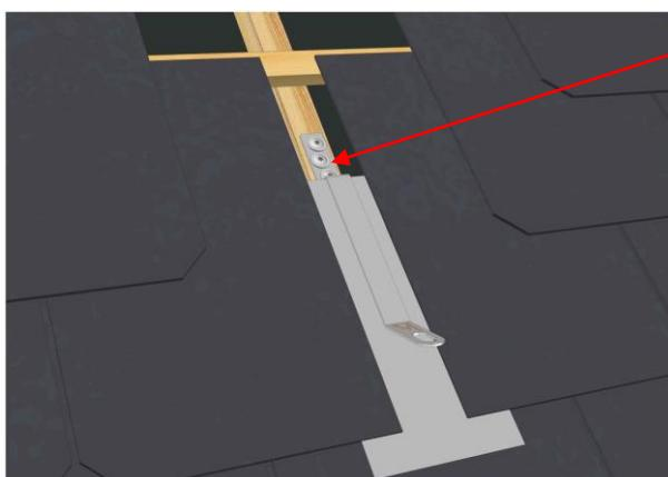
Schraubenlänge **L** wird in Abhängigkeit vom vorhandenen Dachaufbau festgelegt.
