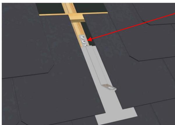
La lunghezza delle viti **L** viene stabilita in base alla struttura esistente del tetto.
