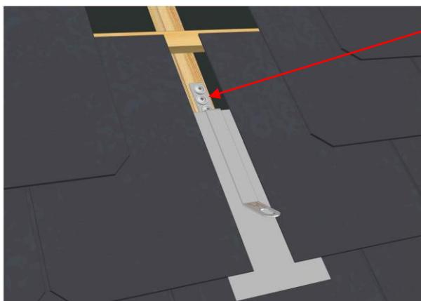
La longueur de la vis **L** sera déterminée en fonction de la construction de la toiture.
