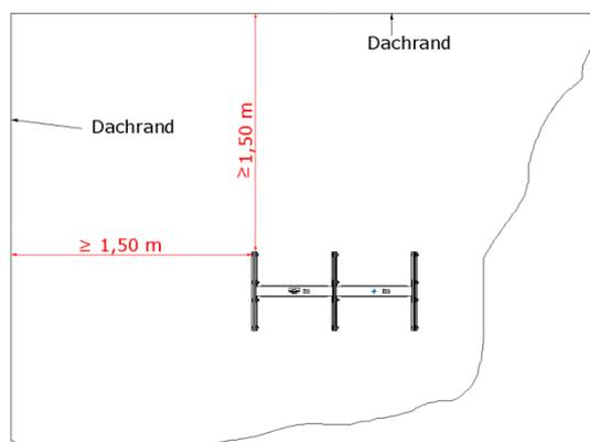
Die richtige Auswahl und Anordnung von permanent auf der Dachfläche vorzusehenden Anschlagvorrichtungen ist in Abhängigkeit der Art und Nutzung der Anschlagvorrichtung unter Berücksichtigung der Besonderheiten der Dachfläche vorzunehmen.
