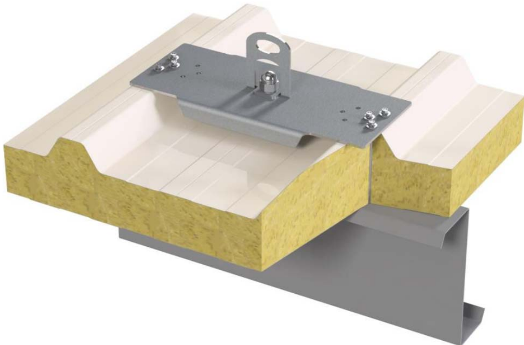
Abbildung 1 - schematische Darstellung der Befestigung
