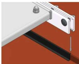
iMontaje sobre cobre sólo permitido usando tiras EPDM (como separador adicional) disponibles en ST Quadrat!
