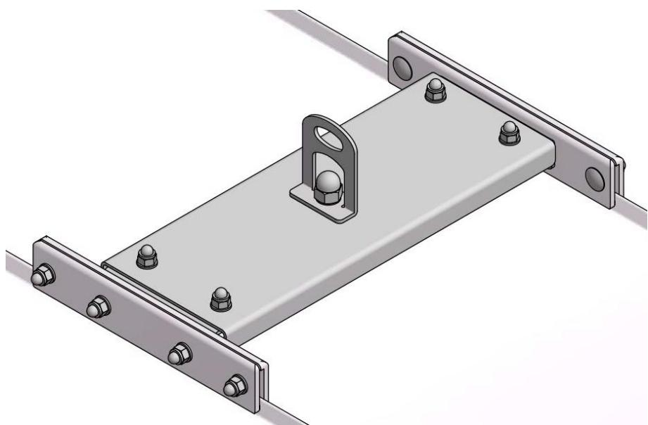
***Point d'ancrage permettant la fixation des équipements de protection individuelle contre les chutes de hauteur (EPI) de 3 personnes maximum ainsi que l'utilisation pour les lignes de vie LUX-top® conformément à la norme DIN EN 795:2012 Type C***
